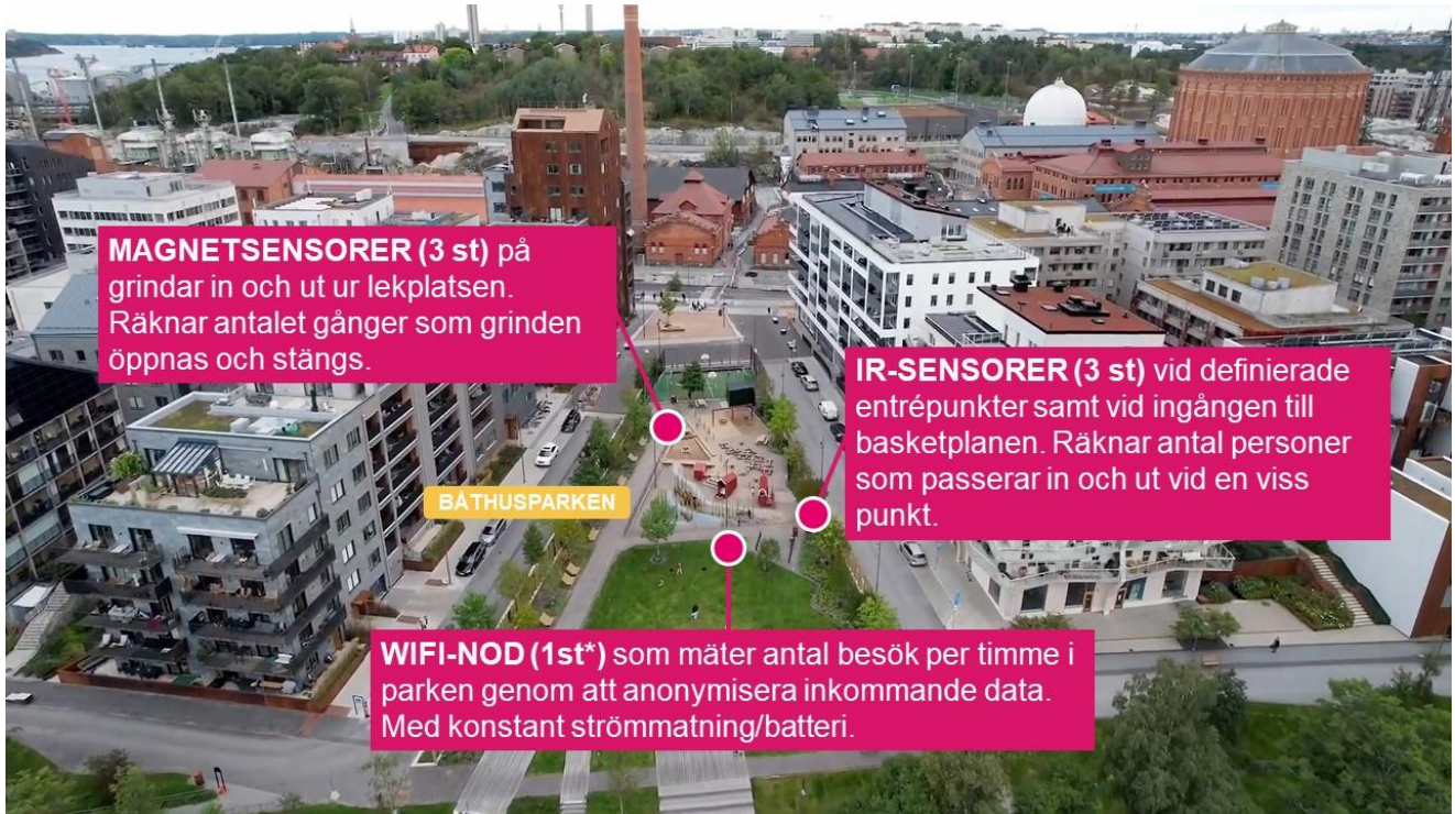
Bild 11: Placering av och funktion hos rörelsesensorer i Båthusparken.
