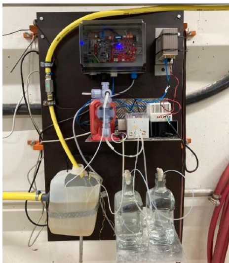
Tillsättning av substanser till dricksvatten i kontrollerad testmiljö för utvärdering av bakteriesensorn. Foto Mats Eriksson, Linköpings Universitet.
