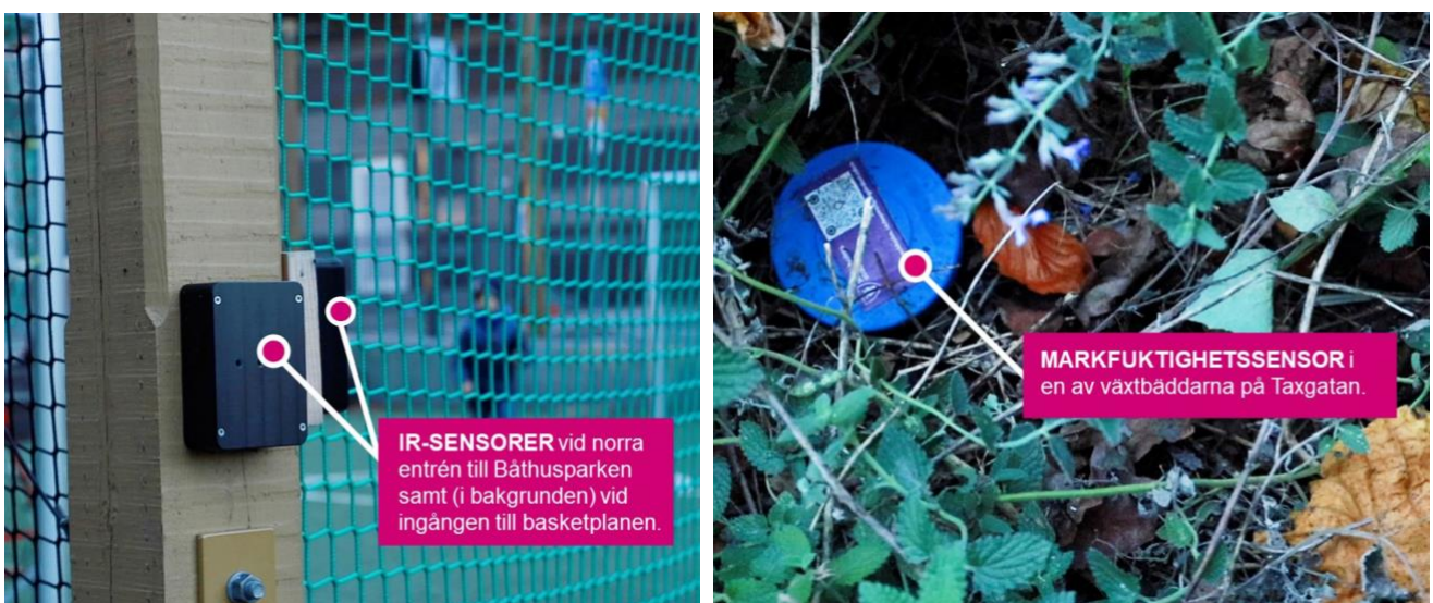
Bild 11: Placering av och funktion hos rörelsesensorer i Båthusparken.
