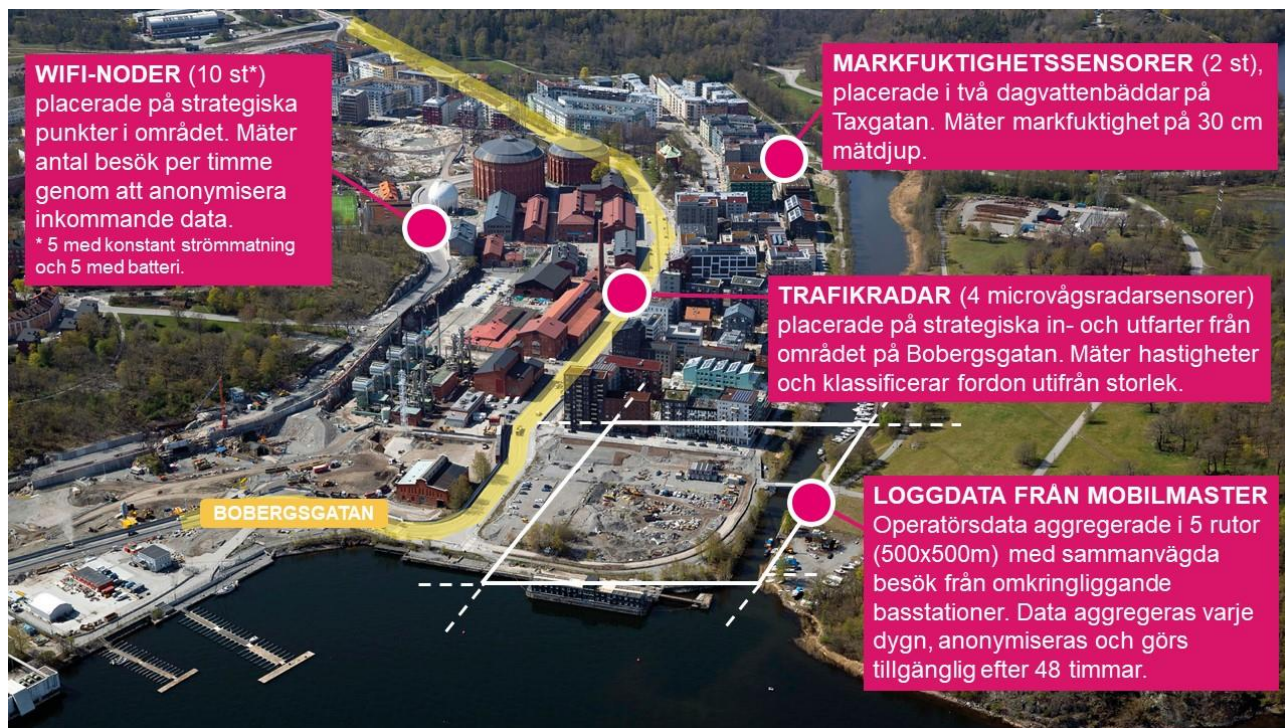
Bild 9: Placering av Wifi-noder och trafikradars samt rutnät för aggregering av loggad operatörsdata inom Piloten Resvanor och mobilitet; samt placering av markfuktighetssensorer inom Piloten Grönytor och parker.
